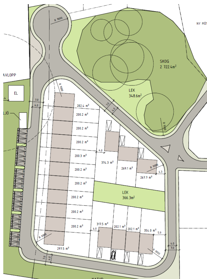
Bild visar förslag på vägstruktur med 7 meter bredd varav enbart 4 meter är hårdjord.
