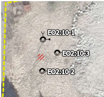
Figur 4.2 Provplan för avgränsning av påträffade förhöjda halter oljeämnen.
