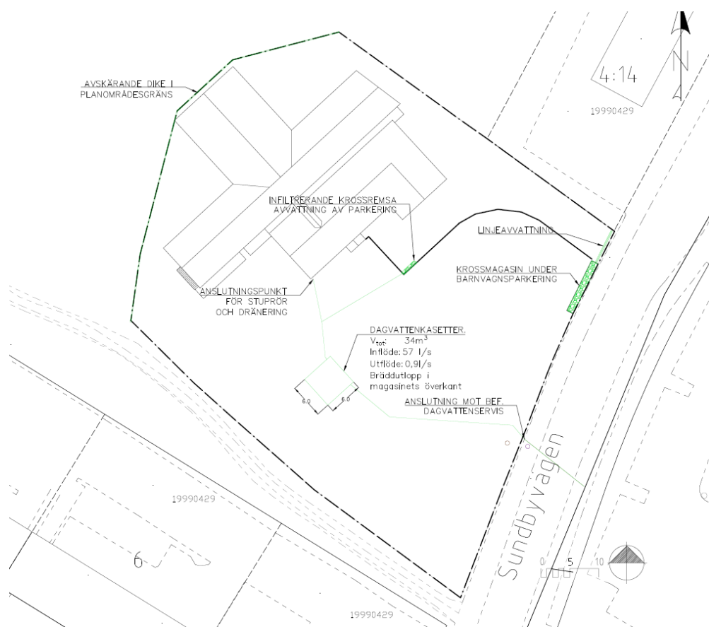
Fig. 25, Placeringsförslag för dagvattenmagasin
