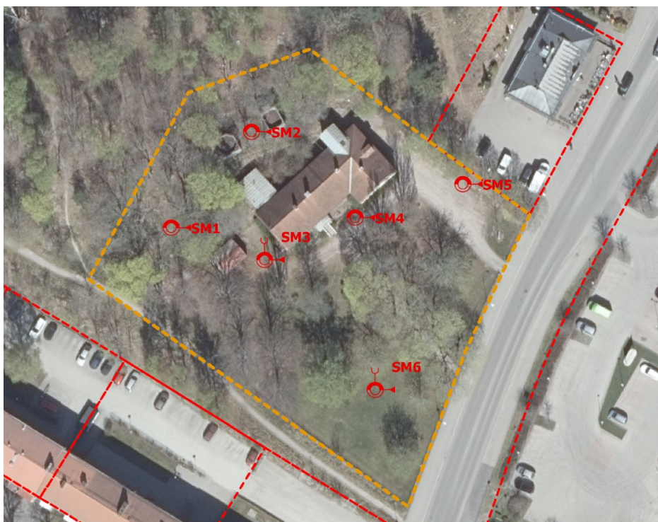
Bild 3, Utredningsområdet är markerad med orange linje. Provtagningsområdet upptar en yta om ca 5000 m 2 . Bilden visar provtagningspunkter.
