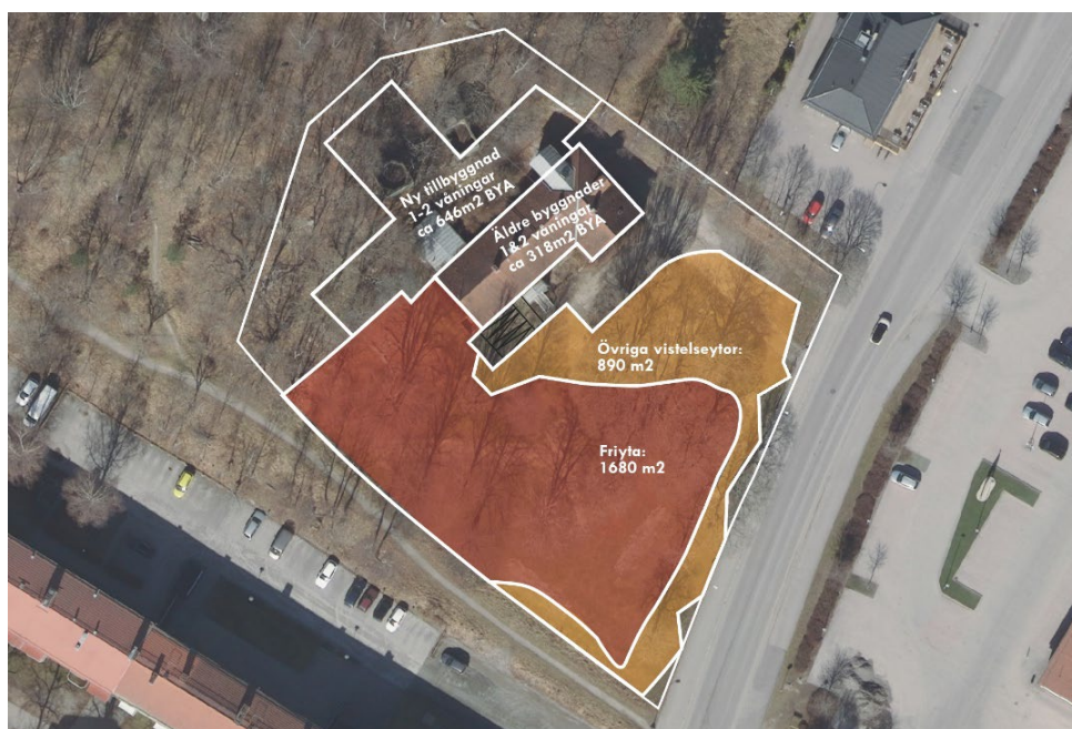
Fig. 21, Beräknad friyta och övriga vistelsezoner som följer riktvärdena med bullerskydd på minst 2,5 meter.
