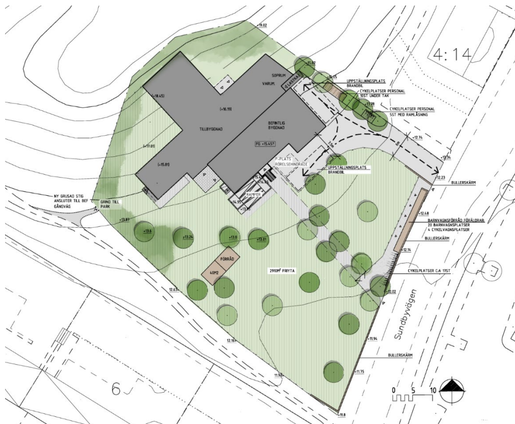
Fig. 12, situationsplanen visar hur området kan utformas. Nya tillbyggnader föreslås norr om befintliga byggnader.
