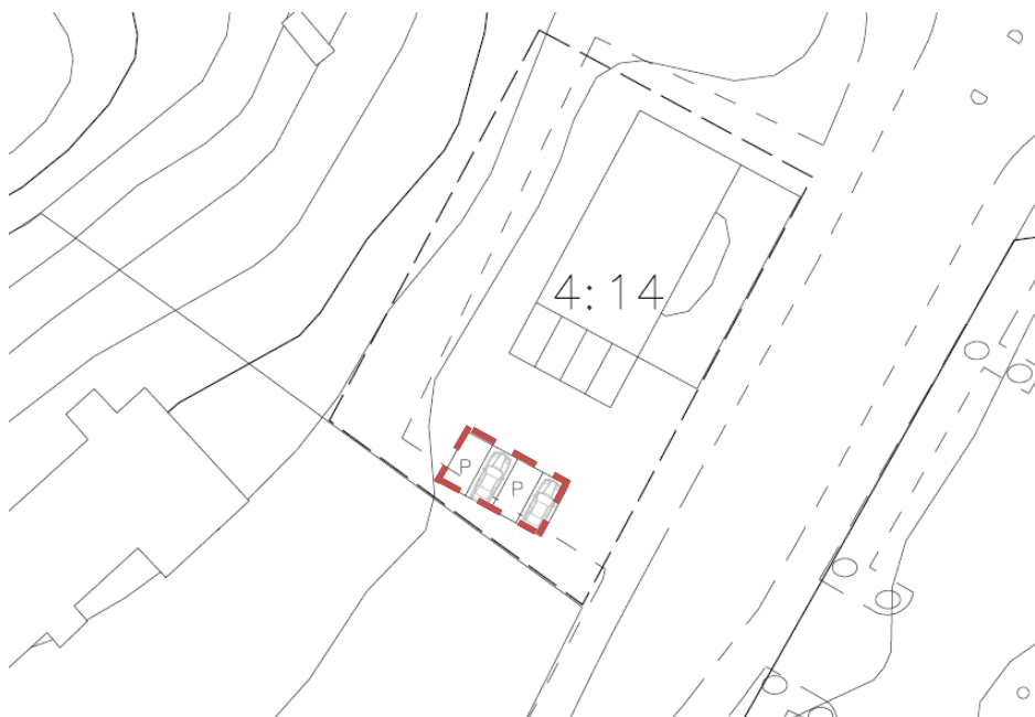
Fig. 19, bilden visar ett förslag på hur hämta/lämna parkeringen kan lösas på en av alternativ fastighet. Förslaget innebär att två nya parkeringsplatser tillskapas på fastigheten genom ett ingrepp i den gröna remsan som finns mellan den asfalterade ytan och fastighetsgräns.
