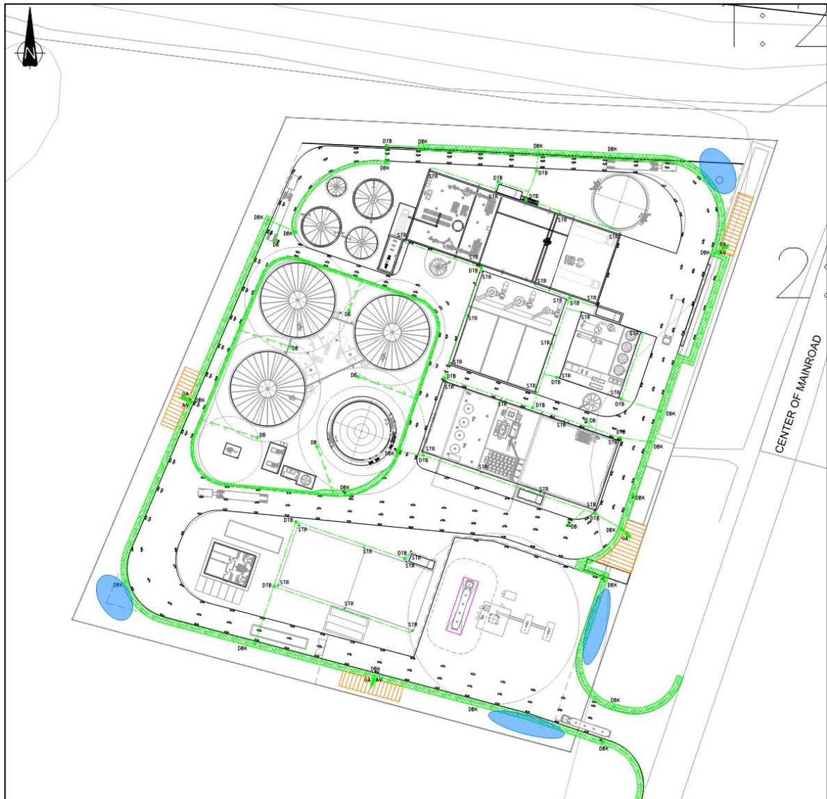
Figur 5-1. Föreslagen dagvattenplan upprättad av Tuna Entreprenad 2022-09-26. Svackdiken redovisas i grön, torrdammar i blått och infiltrationspunkter i orange.
