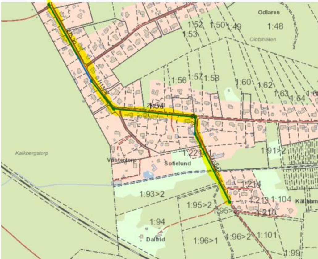
Figur 3. Befintlig huvudledning för spillvatten behöver bytas ut inför påkoppling av ny bebyggelse (Eskilstuna Energi & miljö, 2021a).
