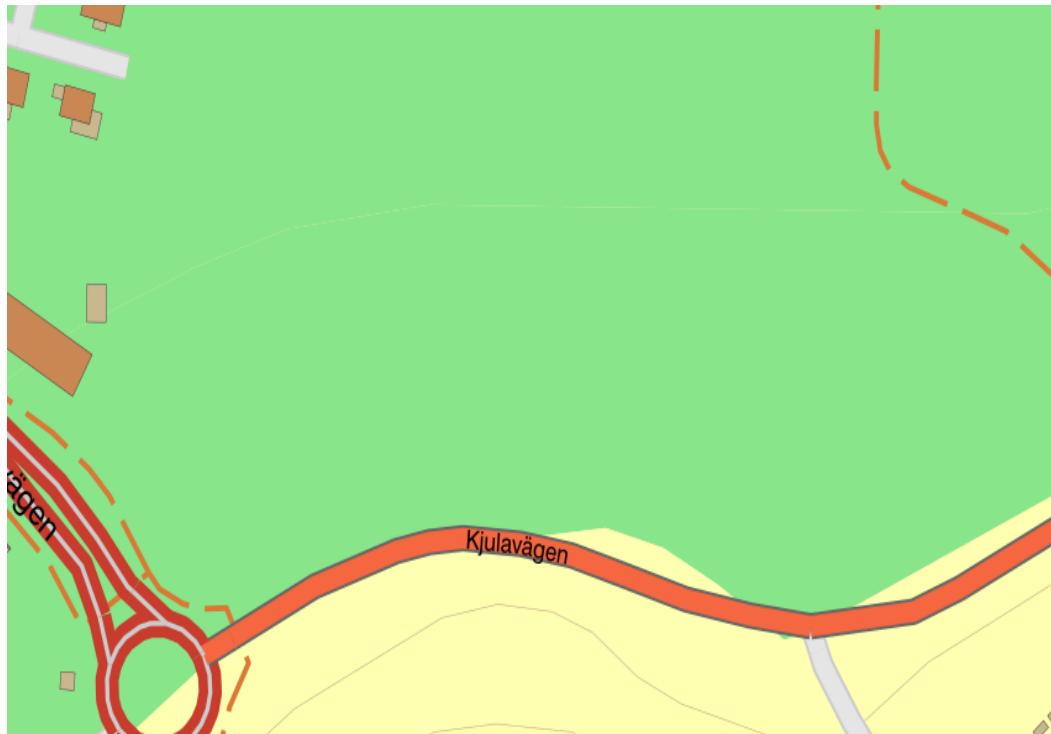
Figur 18. Genomsläpplighet norr om Kjulavägen, Grönmarkering innebär låg genomsläpplighet och gult medelhög genomsläpplighet källa: SGU
