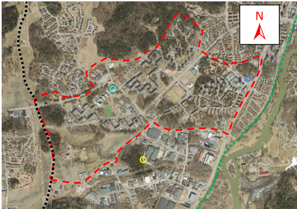
Figur 5-1. De identifierade riskobjekten i förhållande till detaljplanen som syns i rött. Drivmedelsstationen är markerad med blå ring, Sala-Oxelösundsbanan är markerad i grönt och gasoltanken belägen på fastigheten Löddret 3 i Vilsta industriområde är markerad i med gul ring. Inom detaljplanen finns också en pumpstation för fjärrvärmenätet, klassad som miljöstörande verksamhet. Pumpstationen, markerad med turkos ring, bedöms dock inte utgöra ett riskobjekt som kommer att analyseras vidare.
