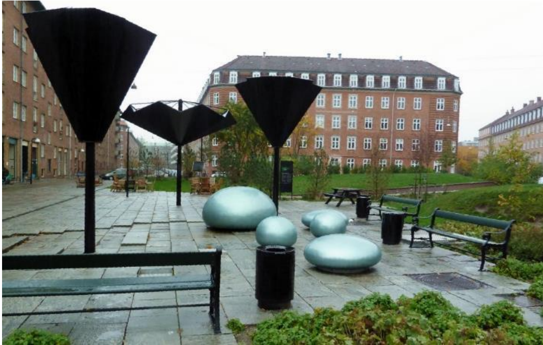
Figur 19. Regnparasoll och vattendroppar på Tåsinge plads. Parasollen samlar upp regnvatten och ger skydd mot regnet. Vid vattendropparna kan renat dagvatten från taktytor genom underjordiska magasin pumpas upp till ytan med manuella pumpar.
