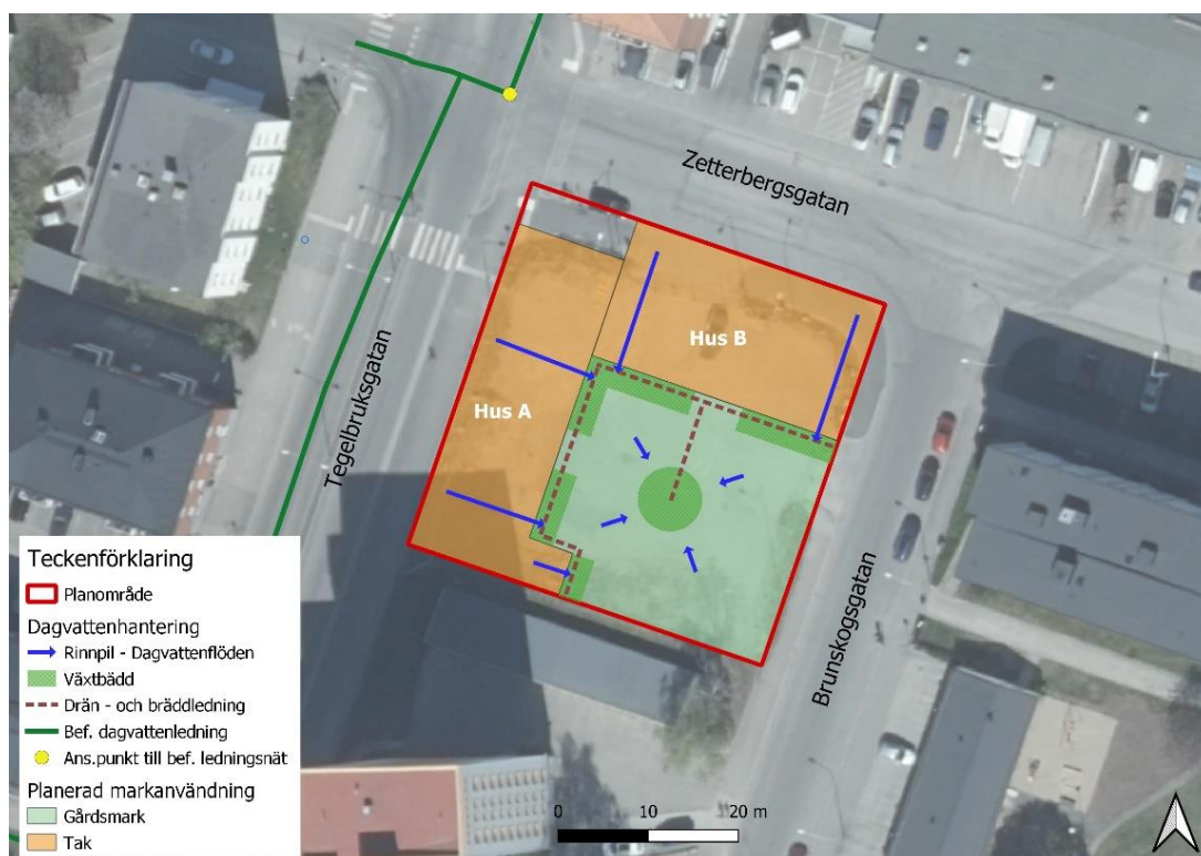
Figur 12 Föreslagen dagvattenhantering inom kvartersmarken. Takytorna avvattnas mot och omhändertas inom gårdsmarken. Total area för illustrerade växtbäddar är ca 145 m 2 . Drän- och bräddledningar ansluts till kommunalt dagvattennät i Tegelbruksgatan.
