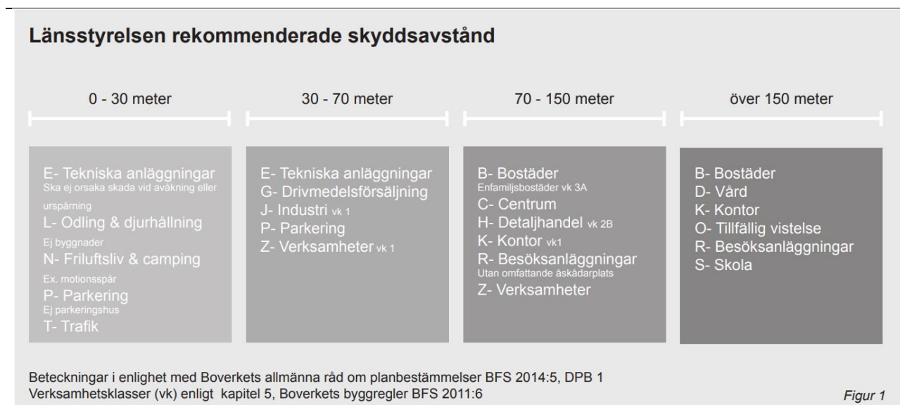
Figur 7. Utdrag från länsstyrelsen Sörmlands riktlinjer för hänsyn till transport av farligt gods i den fysiska planeringen (2015).
