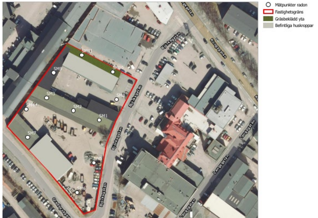
Figur 37. Provtagningsplan med mätpunkter för Valnöten 6 och 14 (Structor, 2021)
