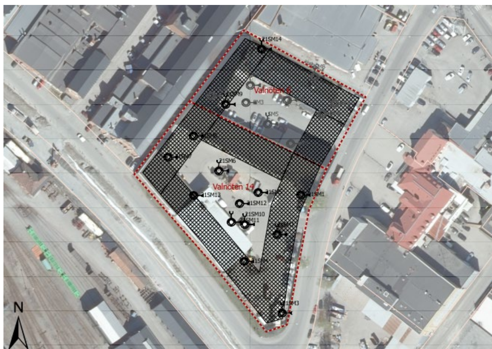
Figur 26. Provtagningsplan med borrhullspunkter för Valnöten 6 och 14 (Structor, 2021).
