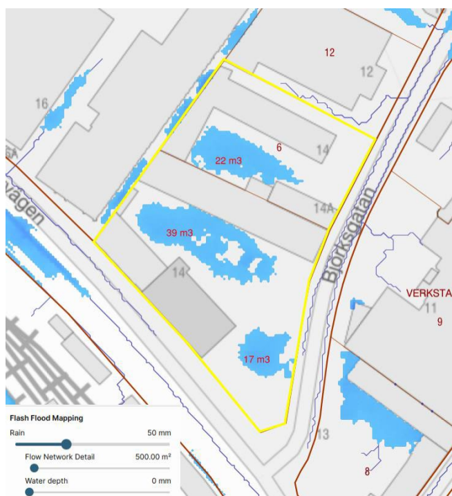
Figur 42. Befintlig situation vid 50 mm nederbörd. (www.scalgo.com).
