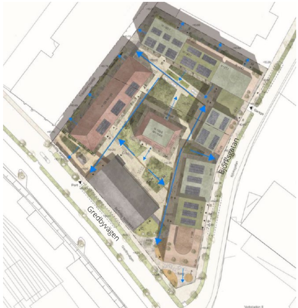
Figur 40. Ytliga avrinningsvägar i framtida planerad situation (Structor, 2023)
