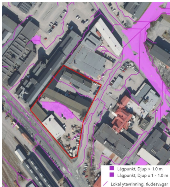
Figur 41. Lokal ytavrinning, flödesvägar och lågpunkter (Eskilstuna kommun, 2023).
