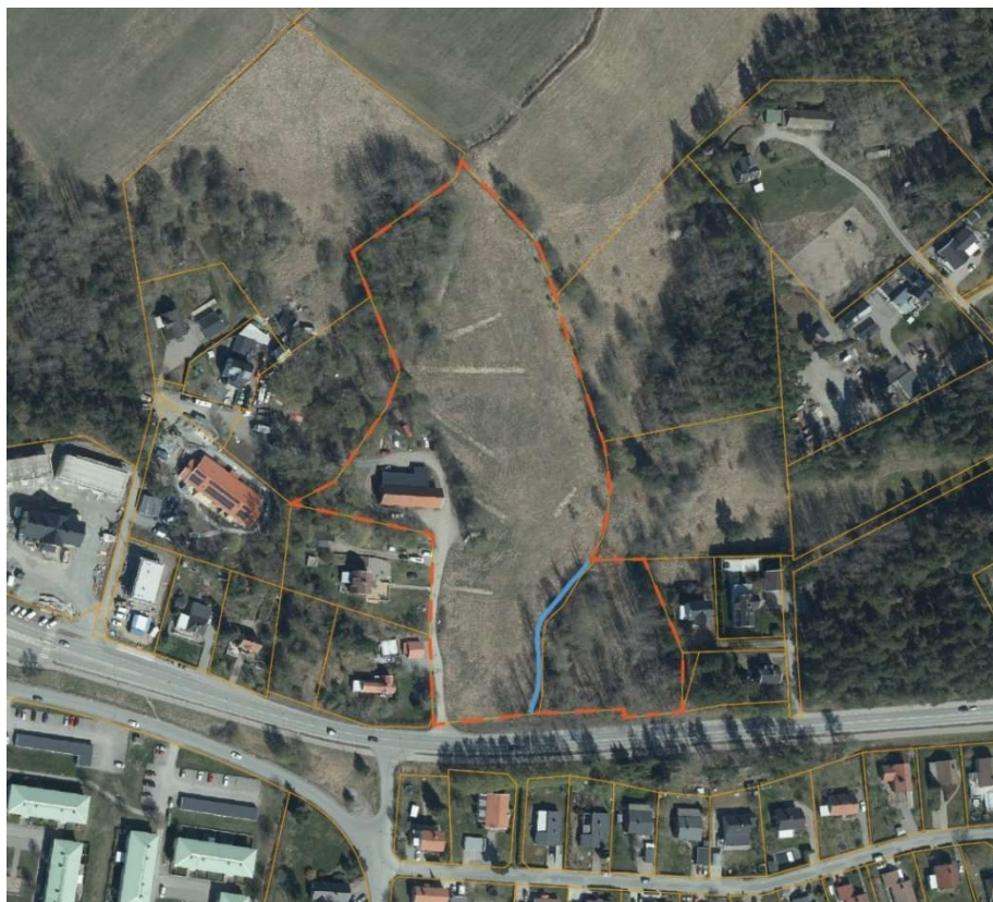
Bild 8, Det blåmarkerade området visar den föreslagna kulverteringssträckning.
